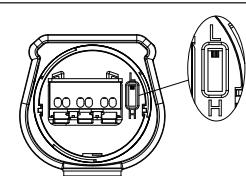
Sélectionner le niveau de puissance maximale : H (haut) ou L (bas). Raccorder le câble d'alimentation. Phase sur L Neutre sur N Terre sur son symbole
