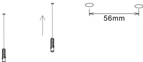
Percer et insérer les chevilles dans les trous prévus au plafond.
