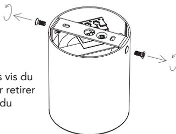
Desserrer les vis du support pour retirer l'enveloppe du luminaire.
