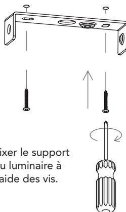
Fixer le support du luminaire à l'aide des vis.
