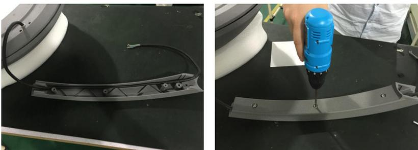
3. Positionnez le bras sur le couvercle du luminaire et vissez-le sans serrer.
