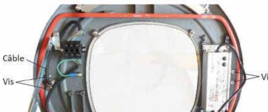
3- Placer la partie centrale reliant les poignées de fixation au mât. Visser les 4 vis (fournis).
