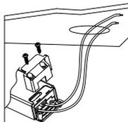
2. Utiliser un tournevis pour ouvrir le couvercle des bornes du pilote, alimenter le fil AC principal L.N. dans le bornier respectivement, puis fixez le couvercle.
