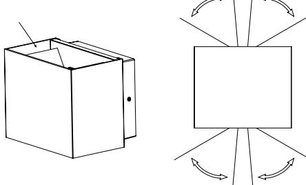
L'angle du faisceau peut être ajusté en orientant les volets.
