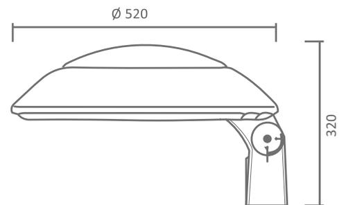
Adaptable sur tube Ø 60 mm
