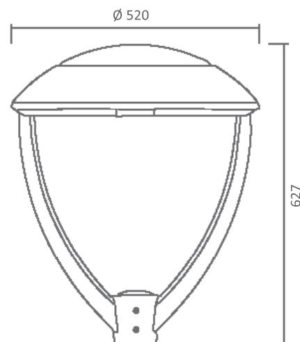
Adaptable sur tube Ø 60 mm
